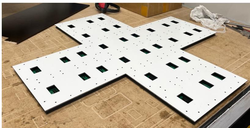
Un **Dibond** est inséré entre la partie led et la partie électronique afin d'assurer la bonne rigidité et une **étanchéité maximale** de la croix.
